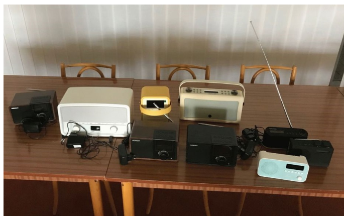
Obr. 2 - Prijímače T-DAB+, použité pri vysielať v laboratórnych podmienkach
