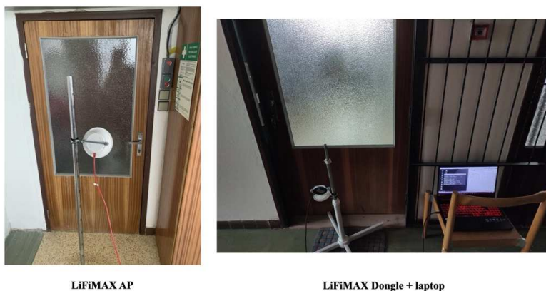
Obr. 4: Meranie prenosovej rýchlosti cez leptané sklo
