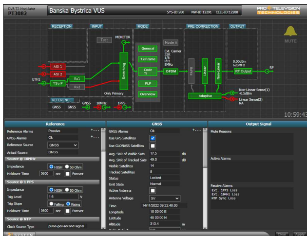
Obr.5 –Bl.schéma modulátora DVB-T B. Bystrica VUS zachyteného na falošný signál spoofing
